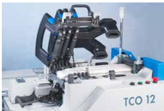
Los cuatro cilindros superiores es posible alzarlos al unísono en una sola acción
