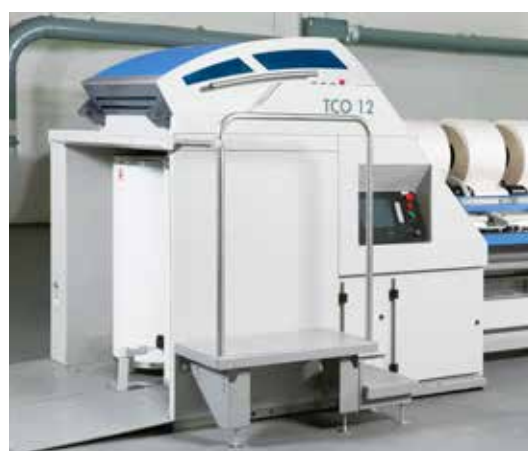
La testera con el cambiador de botes automático y la consola de mando
