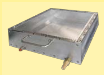
base con molde de formación (y conexión de aire comprimido para sistema de enfriamiento de la prueba)
