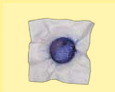
ejemplo de testigo después de teste de fricción
