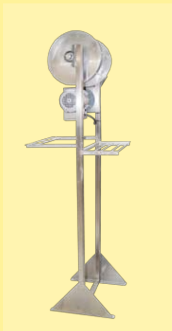
Batidor simple con aspa, sin control de tensión para las cintas
