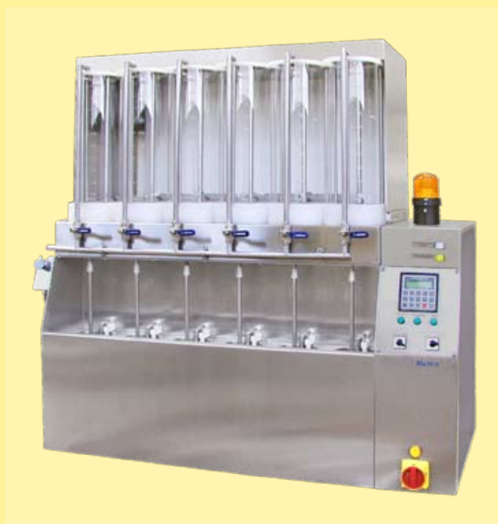
tergotómetro para testar detergentes y jabones (en polvo)
